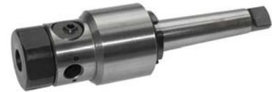
Tipo di alta precisione con compensazione a compressione (Gr.10 e 16: mm 3,5 circa / Gr. 24: mm 4 circa) e trazione (Gr.10 e 16: mm 10 circa / Gr. 24: mm 15 circa). Adatto su trapani, maschiatrici, fresatrici, torni tradizionali e macchine NC, con inversione di marcia.
